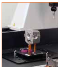
K551218 : Utilisation du système de palettisation inférieur
